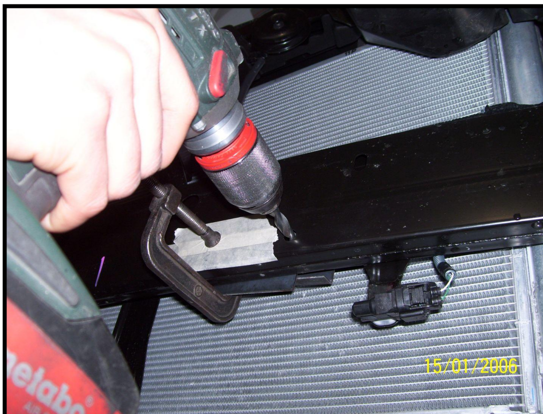
Wywiercić dwa otwory \varnothing 9 w przedniej belce przy pomocy podkładki zamocowanej z tyłu belki. Drill two holes \varnothing 9 in the front beam with help of some "safe part" mounted behind beam.
